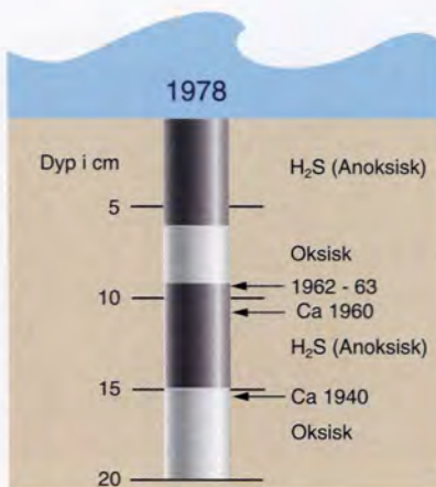
Figur 26. Dette er en sedimentkjerne fra Bunnefjorden. Den ble tatt i 1978 på 150 m dyp. Kjernen ble aldersdatert ved å måle aktiviteten til den naturlige blyisotopen (bly 210). Den gjennomsnittlige tilveksten av sediment i de øvre 20 cm ble beregnet til 4.8 mm pr. år. Øverst var sedimentet svart (sulfidholdig) og forteller at vannmassene i hovedsak har vært råtne, dvs. uten oksygen og uten muligheter for marint liv. Av kjernen fremgår at før midten av 1940-tallet var vannmassene i hovedsak oksiske, selv om det i korte perioder ble registrert råttent vann. Siden slutten av 1940-tallet frem til begynnelsen av 1960-tallet var periodene med oksygen i dypvannet så korte at sedimentet fortsatt var råttent. En kort periode på 1960-tallet var dypvannsfornyelsen så god og regelmessig at sedimentet også ble oksiskt. Sedimenthistorien forteller oss at Bunnefjorden en gang har vært bedre enn den er i dag.
