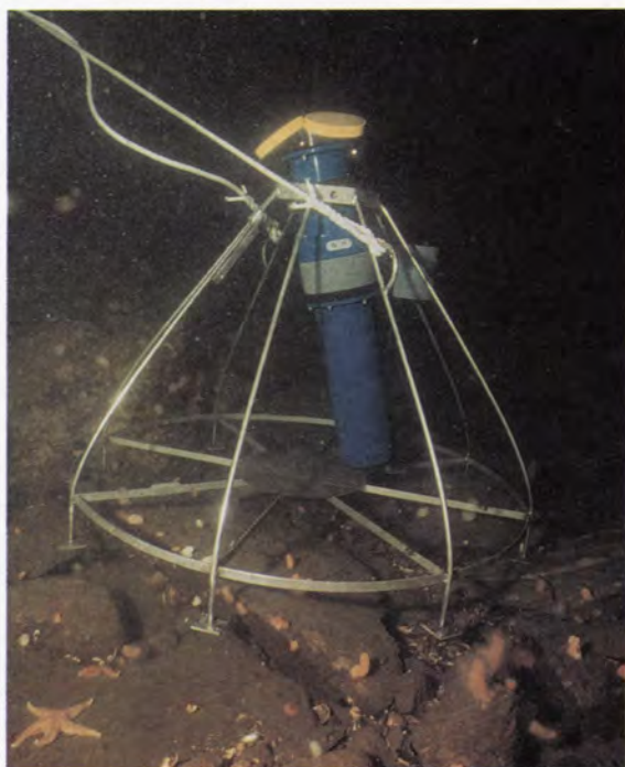
Figur 12. Strømmåler av type ADP (NORTEK) på bunn. Den fungerer omtrent som et ekkolodd hvor lydsignaler sendes ut og reflekteres av partikler på ulike dyp. Derved kan hastigheten beregnes (Dopplereffekten). De gule skivene øverst (3 stykker) på måleren er svingehodene som sender ut lydimpulser med jevne mellomrom.
